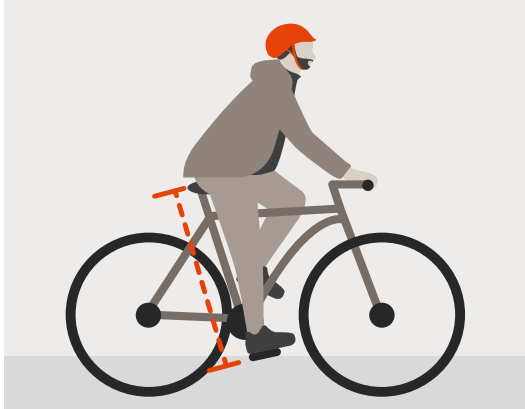
Sattelhöhe prüfen: Ferse aufs Pedal stellen; Knie ist nur leicht angewinkelt
