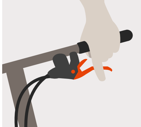
Bremshebel einstellen: Zeige- und eventuell Mittelfinger erreichen den äusseren Rand
